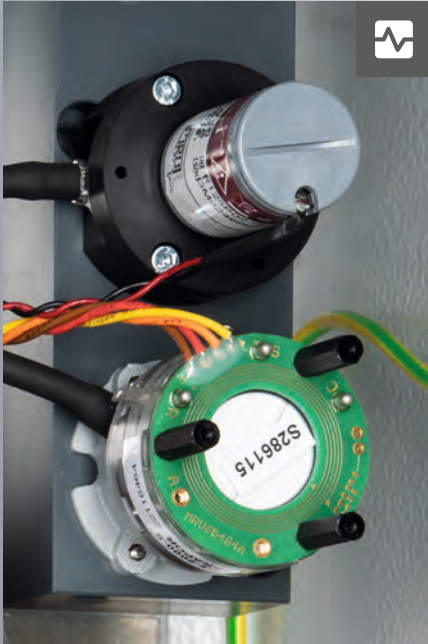
Elektrokimyasal sensörler H 2 S ve O 2 ölçümleri için
