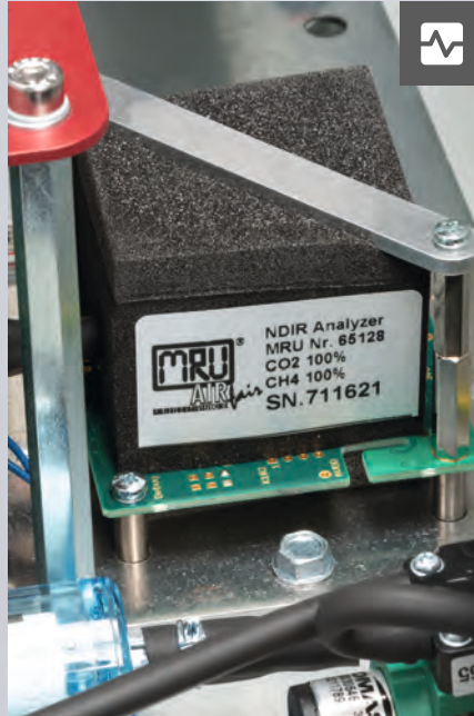
NDIR sensör bloğu CH 4 /CO 2 analizi için, biyogaz ve çöp gazı ölçümleri için
